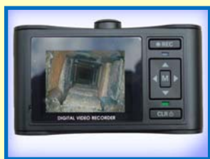
2" bildskärm med inspelning på SD-kort och strömförsörjning till kamera 501 033 107
